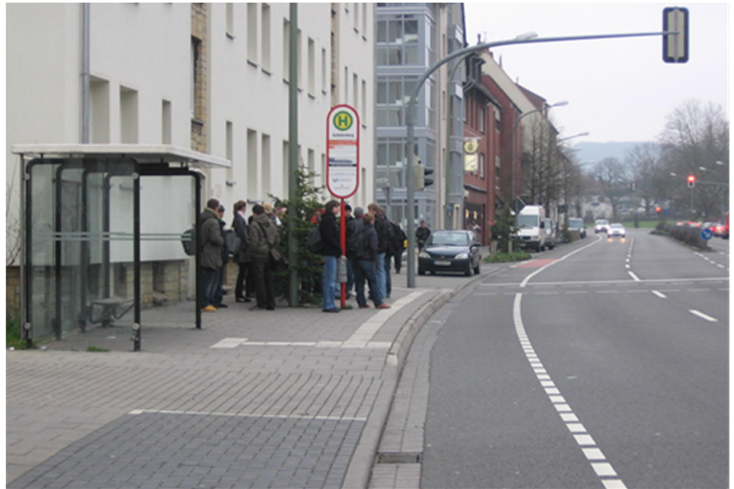
Abb. 50 Führung des Radverkehrs auf der Fahrbahn im Haltestellenbereich (Beispiel aus Osnabrück)
